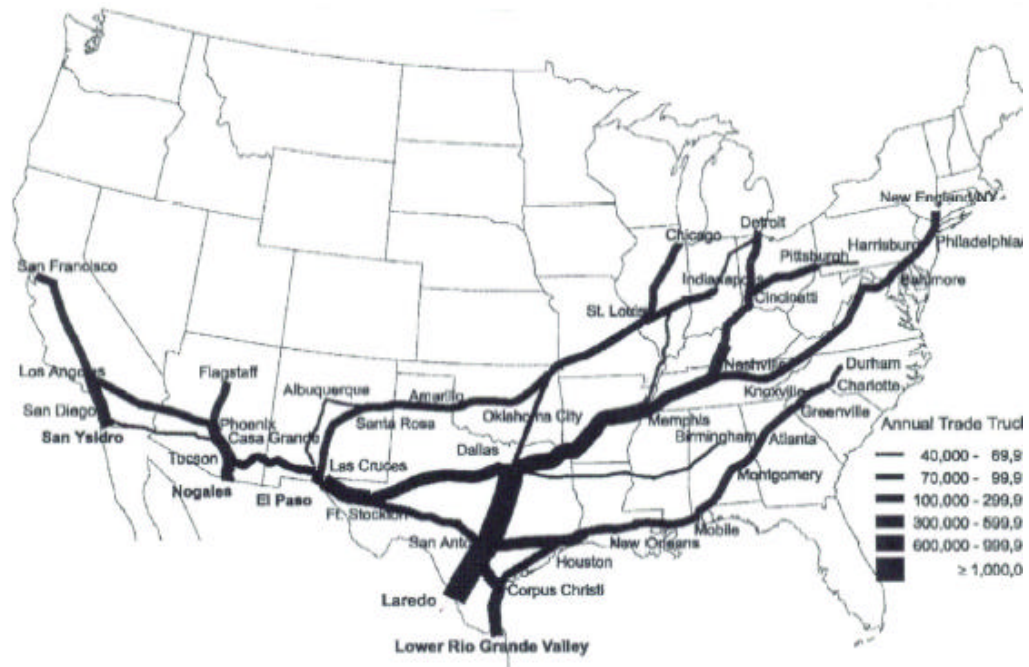
Figura 5. Corredores Dominantes de Comercio entre México-E.E.U.U. Segmentos de Autopista con Más de 40,000 Camiones Comerciales por Año, 1996.
