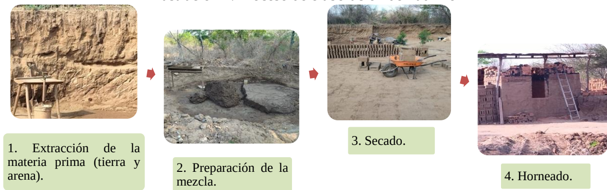
Ilustración 1. Proceso de elaboración del ladrillo
